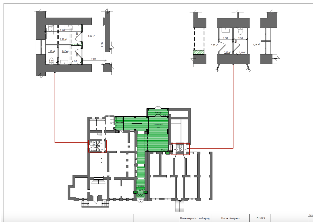
Рис. 3.5. Проектні планувальні рішення із забезпечення інклюзивності комплексу Національного музею мистецтв імені Богдана та Варвари Ханенків прилегло до вулиці Терещенківській №15, №17. Архітектори: І.Коротун, С.Стоян.
